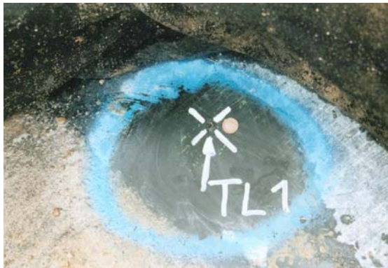
Bild 12: Testloch mit 5,0 mm Durchmesser
