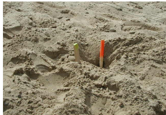
Bild 17: Vorgegebene und geortete Position der Testleckage.
