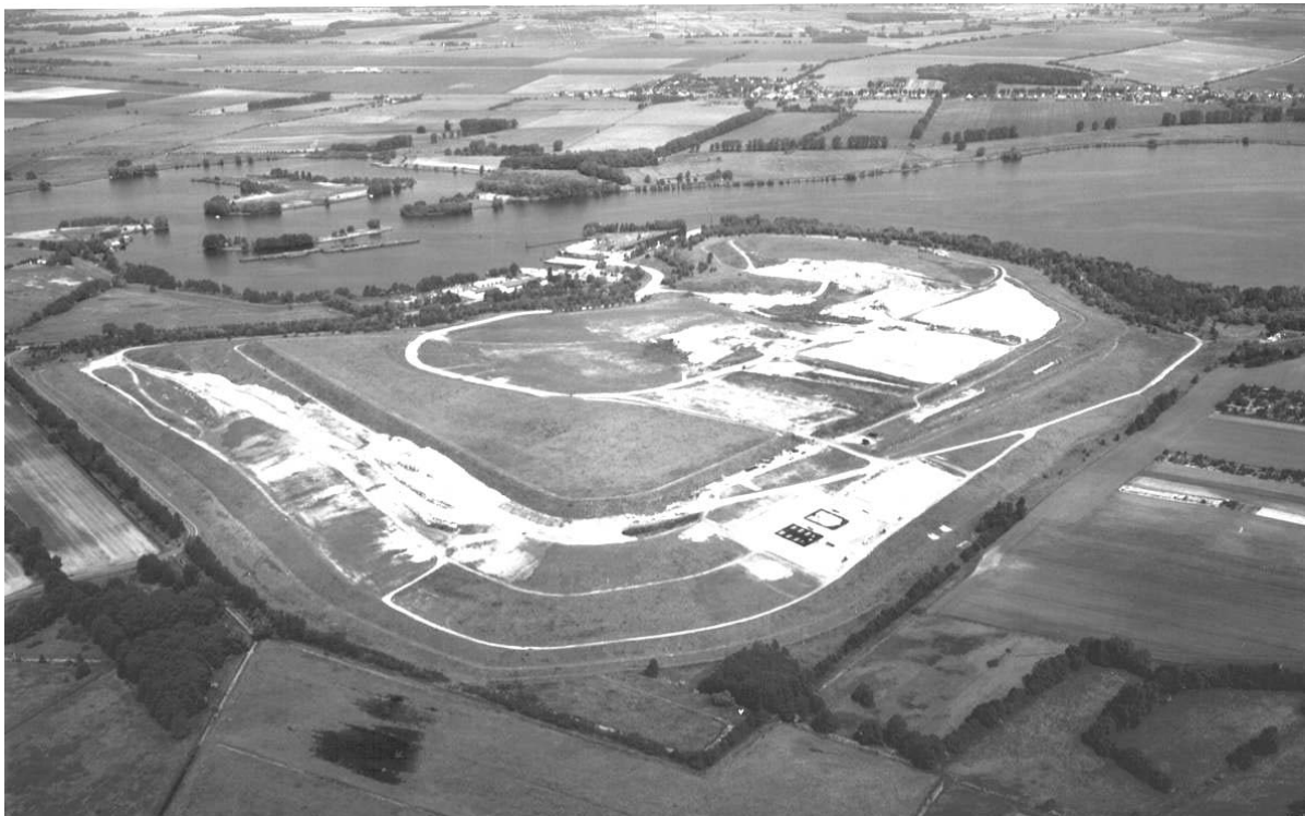
Bild 1 Luftbild der Deponie Deetz aus dem Jahr 2002 (im Vordergrund rechts: Herstellung der Versuchsfelder auf der Ostböschung der Deponie)
