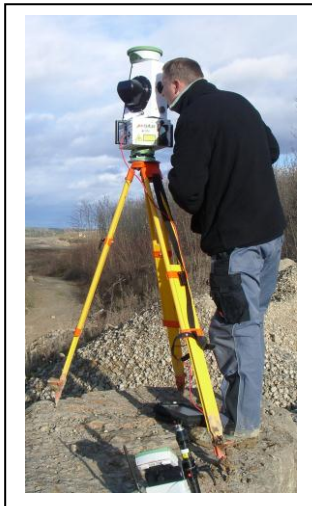
Abb. 2: Scanneraufbau mit Teleskop und GPS
