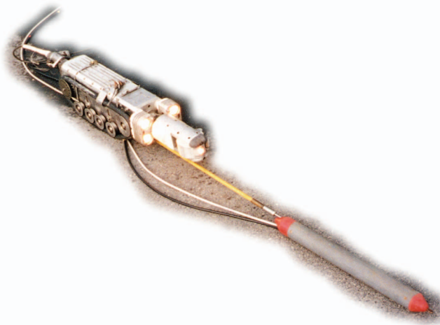
Abbildung 3: Kamerafahrzeug mit aufgestecktem hydrostatischem Sensor
