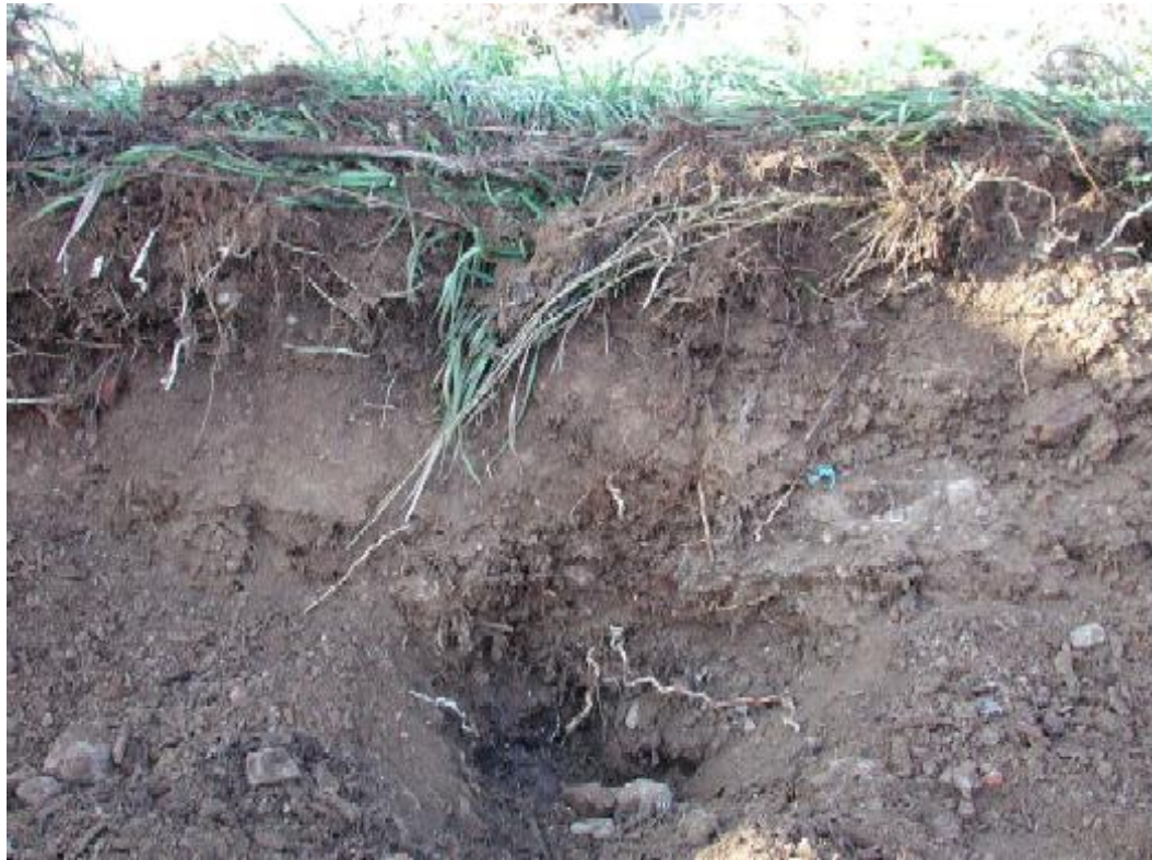
Abb. 5: maximale Durchwurzelung der Rekultivierungsschicht ca. 80-90 cm
